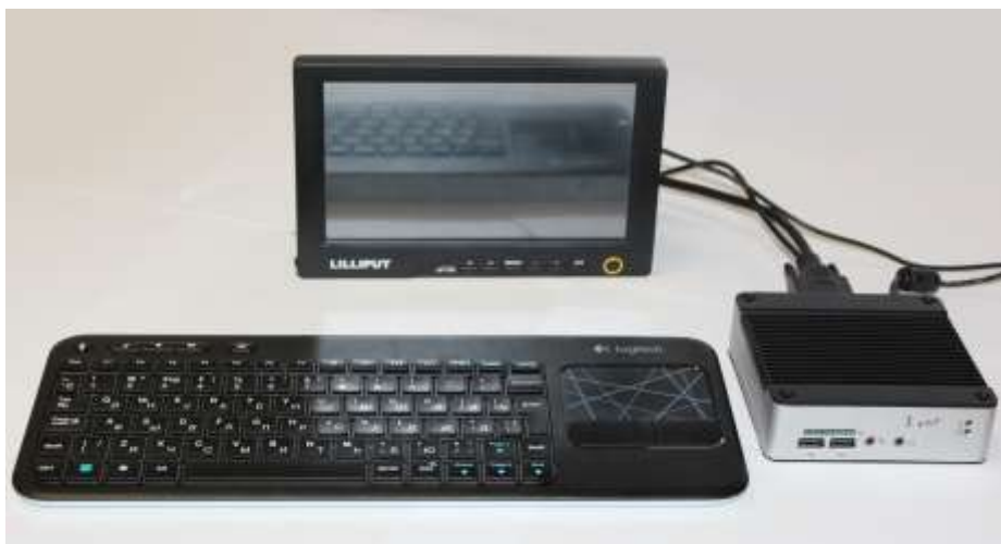
Рис. 11 Миникомпьютер Ebox 3310mx-ap
